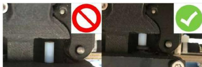
Не забудьте включить принтблок в разъём на плате и закрепить упор на место! После этого можно вставить переднюю панель печатающей головки на место движением сверху вниз, так, чтобы края панели попали в соответствующие пазы на боковых стенках корпуса.
