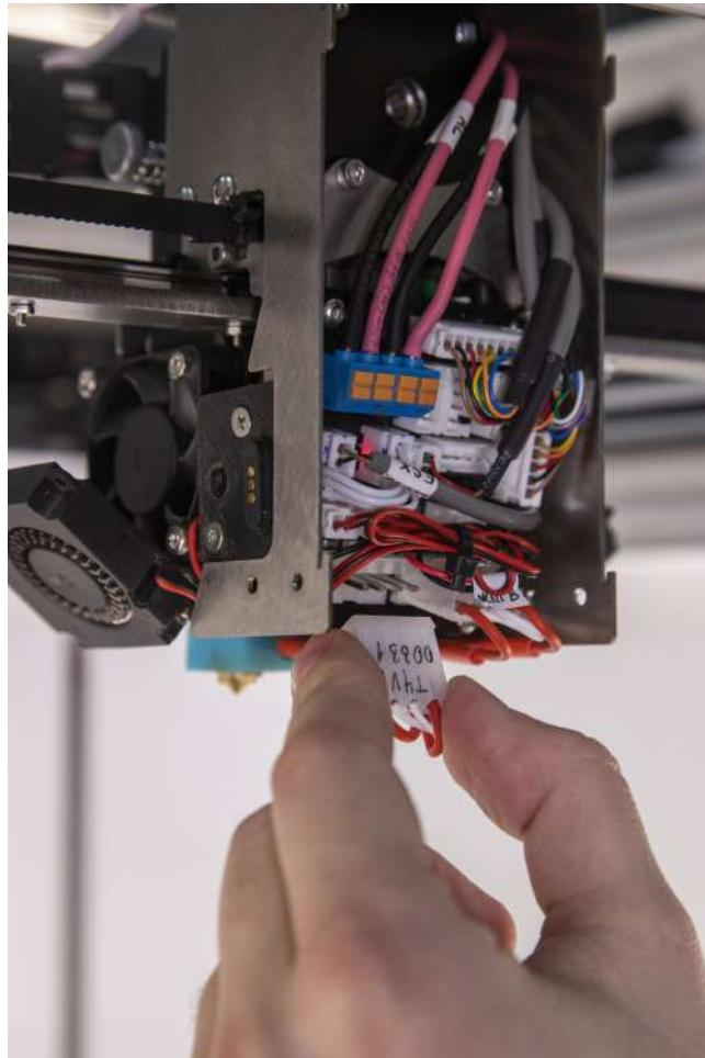
На задней стороне печатающей головки находятся два болта, удерживающие основной (левый) и вспомогательный (правый) экструдеры. Тем же ключом ослабьте болт, ближайший к основному экструдеру:
