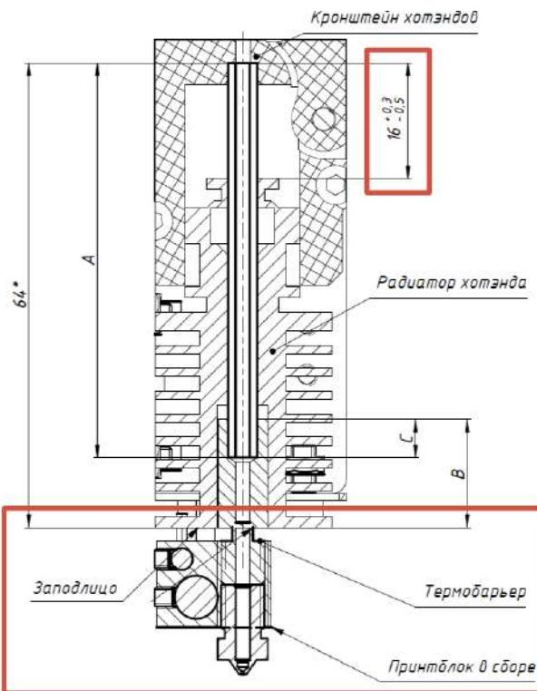
Особое внимание на данные правила установки принтблока следует обратить при использовании принтблоков с нестандартными термобарьерами (биметаллическими и т.д.), которые не входят в базовый или расширенный комплекты ЗИП к принтерам Stereotech.
