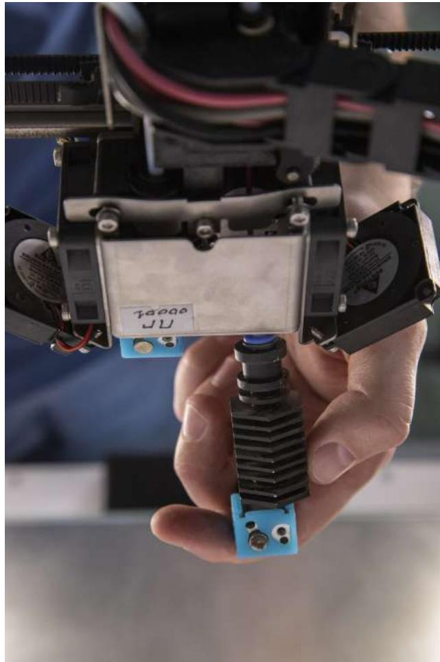
Принтблок устанавливается в радиатор до упора и поджимается одним или двумя установочными винтами по боковой поверхности. Чтобы извлечь принтблок из радиатора, их нужно ослабить другим комплектным ключом:
